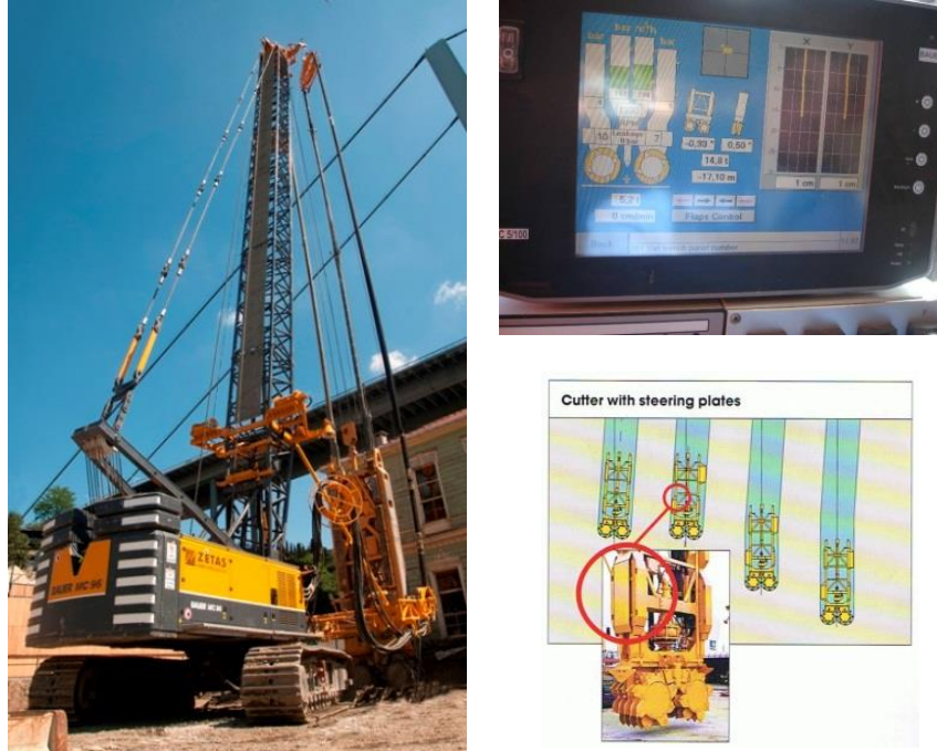
Şekil 5a. Hidrofrez-Cutter tipi Diyafram Duvar Makinesi
